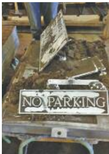
Billedet viser et skilt netop formet i støbeformen. Temperatur ca. 200 grader
